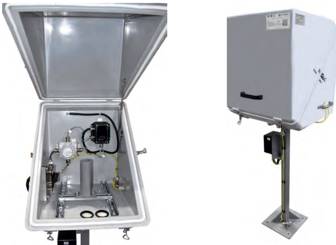
Шкаф защитный, приборный, утепленный диагонального раскрытия для размещения оборудования и приборов КИПиА. Изготавливается по ТУ 26.51.53-009-15701168-2021 из композитных материалов, для работы во взрывоопасных средах.
