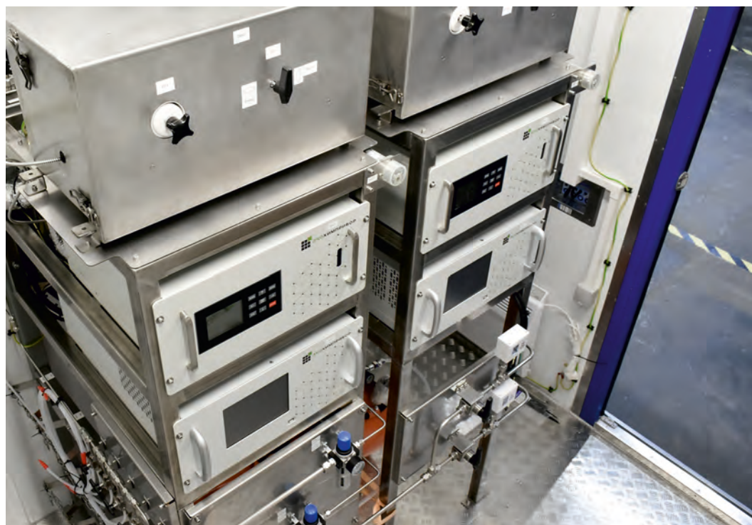
Пример производства системы автоматического контроля выбросов (АСМВ) для металлургического производства
