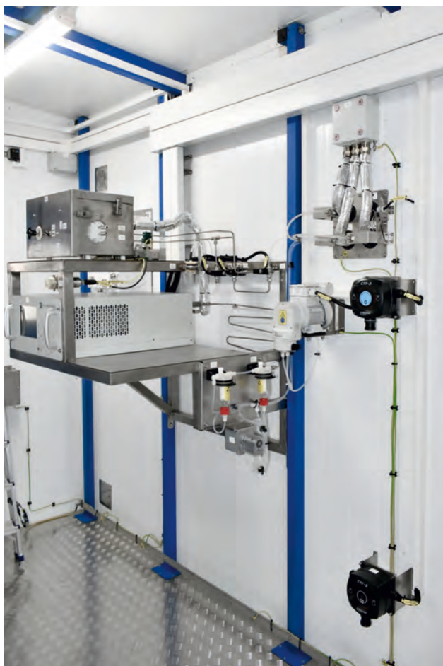
Пример производства системы автоматического контроля выбросов (АСМВ) для цементного производства
