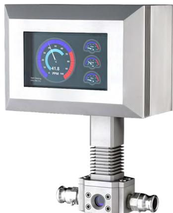
ТЕХНОТОС СВ – поточные анализаторы непрерывного действия. Конструктивно состоят из проточной ячейки, измерительного блока, включающего источник излучения (лазер с длиной волны от 250 до 410 нм) и систему регистрации (фотоприемник и спектрометр) с длиной волны от 340 до 850 нм, блока обработки измерительной информации и управления с процессором и дисплеем, интегрированных в один корпус во взрывозащищенном исполнении. Предназначены для установки во взрывоопасных зонах класса 1 и 2.
