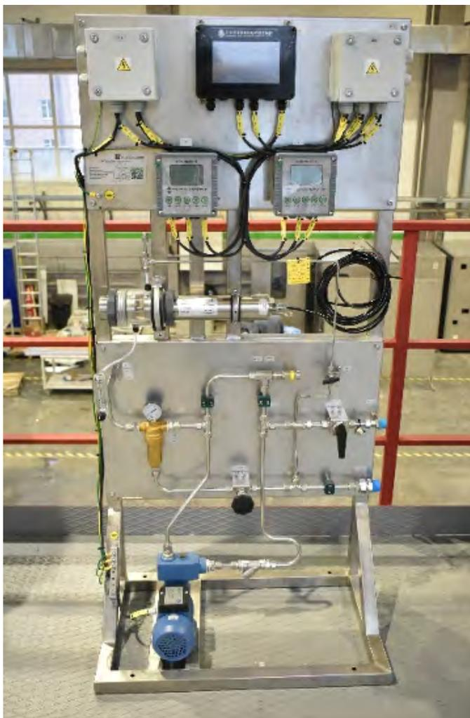
Система для измерения pH, мутности и ХПК
