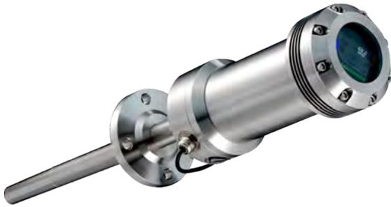
ТЕХНОТОС ВВ – поточные анализаторы непрерывного действия. Конструктивно состоят из зонда, измерительного блока, включающего источник излучения (лазер с длиной волны от 250 до 410 нм) и систему регистрации (фотоприемник и спектрометр) с длиной волны от 340 до 850 нм, блока обработки измерительной информации и управления с процессором и дисплеем, интегрированных в один корпус во взрывозащищённом исполнении. Предназначены для установки во взрывоопасных зонах класса 1 и 2.
