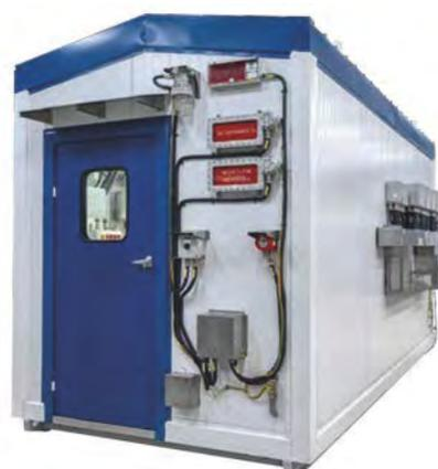
Шелтер «ЭкоБокс» приборный, утепленный для размещения аналитического оборудования. Установка на открытой площадке. Рамная конструкция, цельносварной каркас покрыт маслобензостойкой эпоксидной краской.
