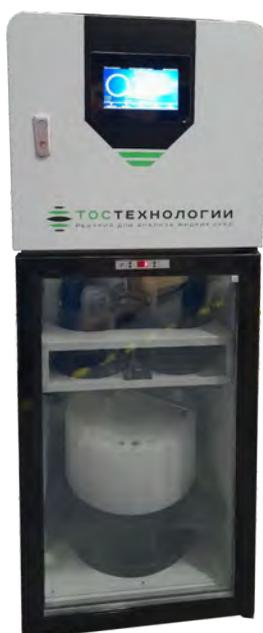
Устройство пробоотборное автоматическое АПВС-Эко - стационарный пробоотборник, предназначенный для полностью автоматического отбора, задаваемого распределения и терморегулируемого хранения жидкостей. АПВС-Эко может использоваться как дополнение к анализаторам АКВАТОС.
