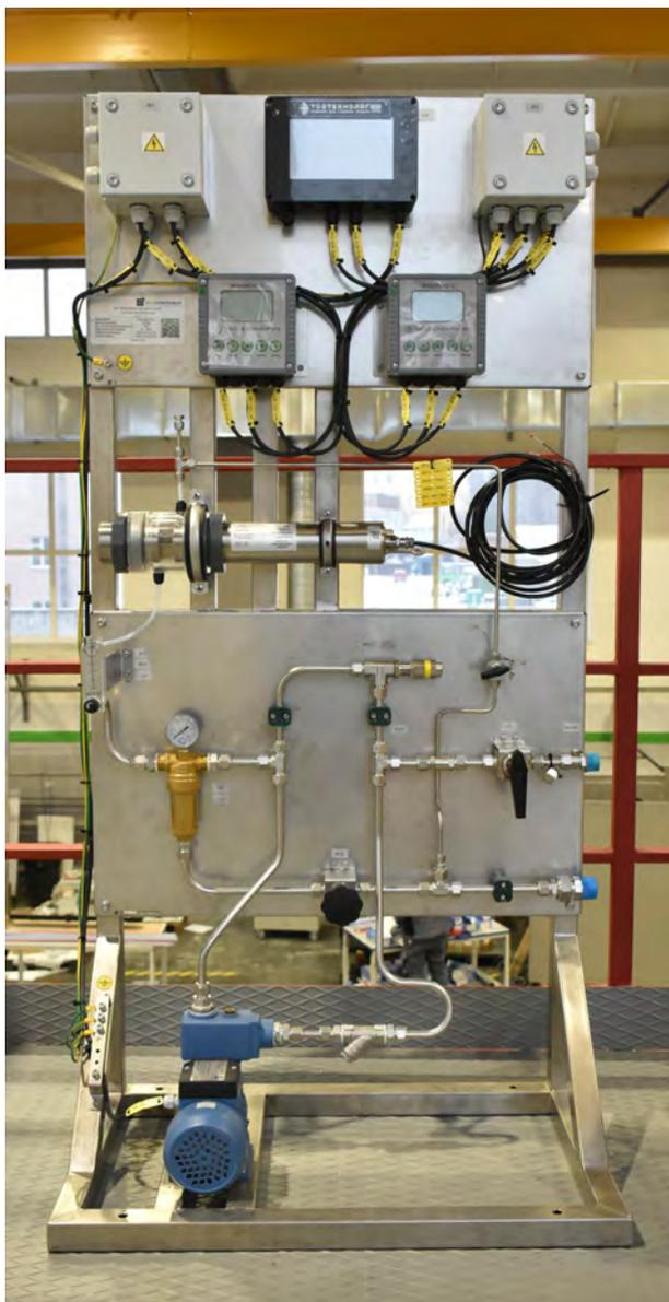
Система для измерения pH, мутности и ХПК
