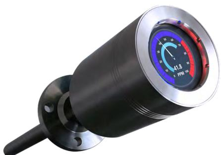
ТЕХНОТОС В – поточные анализаторы непрерывного действия. Конструктивно состоят из зонда, измерительного блока, включающего источник излучения (лазер с длиной волны от 250 до 410 нм) и систему регистрации (фотоприемник и спектрометр) с длиной волны от 340 до 850 нм, блока обработки измерительной информации и управления с процессором и дисплеем, интегрированных в один корпус в общепромышленном исполнении. Предназначены для установки в безопасных зонах.
