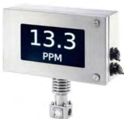
ТЕХНОТОС С – поточные анализаторы непрерывного действия. Конструктивно состоят из проточной ячейки, измерительного блока, включающего источник излучения (лазер с длиной волны от 250 до 410 нм) и систему регистрации (фотоприемник и спектрометр) с длиной волны от 340 до 850 нм, блока обработки измерительной информации и управления с процессором и дисплеем, интегрированных в один корпус в общепромышленном исполнении. Предназначены для установки в безопасных зонах.
